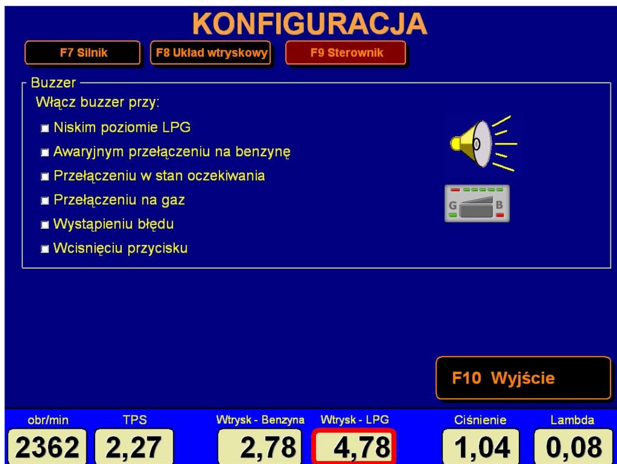
Fig. 4.4. Représentation graphique du menu Configuration → Calculateur du logiciel « GT500S »
