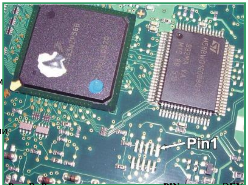
Рис. В: Расположение контактов и PIN на плате ЭБУ
