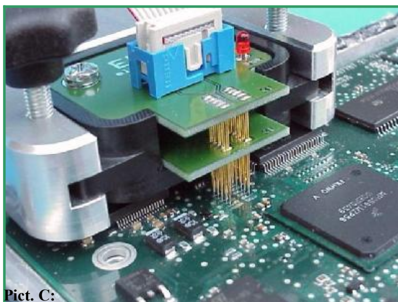
Рис. В: Из 12-ти контактов используется только 10
