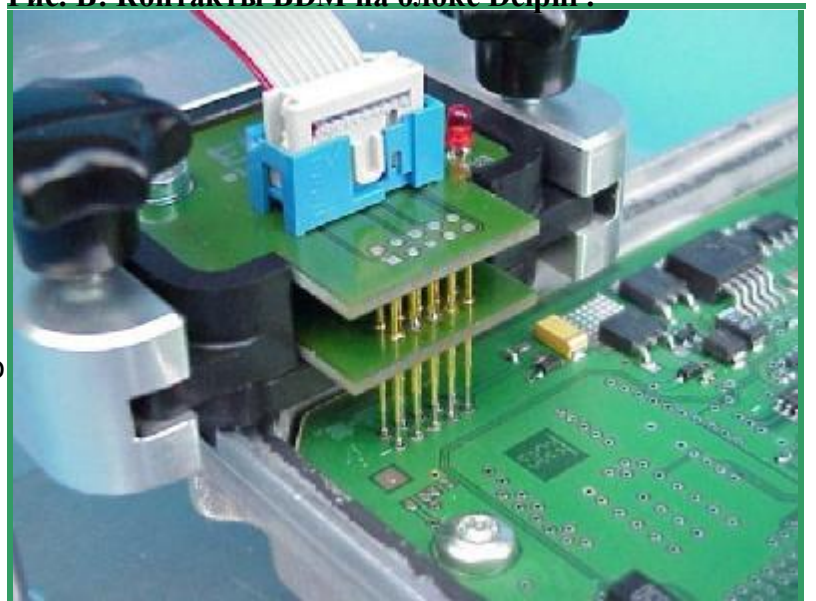
Рис. В: Контакты BDM на блоке Delphi .
