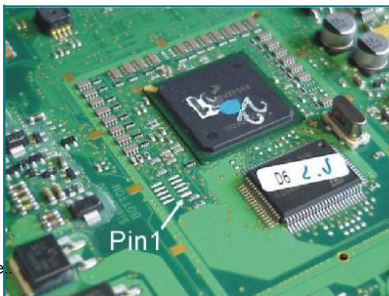
Рис.В Расположение контактов и PIN 1 .
