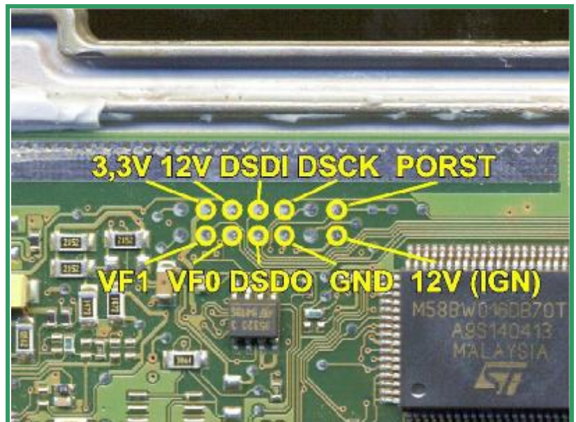
Рис. В: Распиновка контактов для программирования BOSCH.
