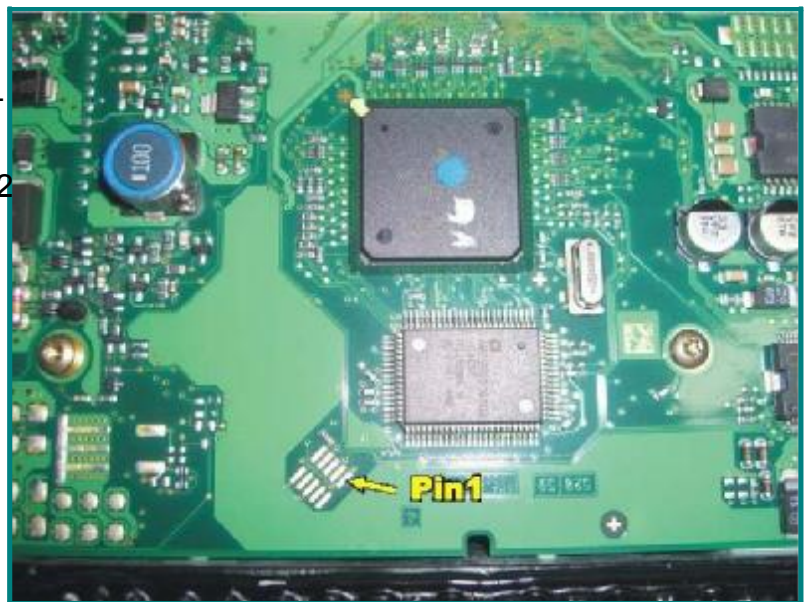
Рис.В Контактная площадка и положение PIN1
