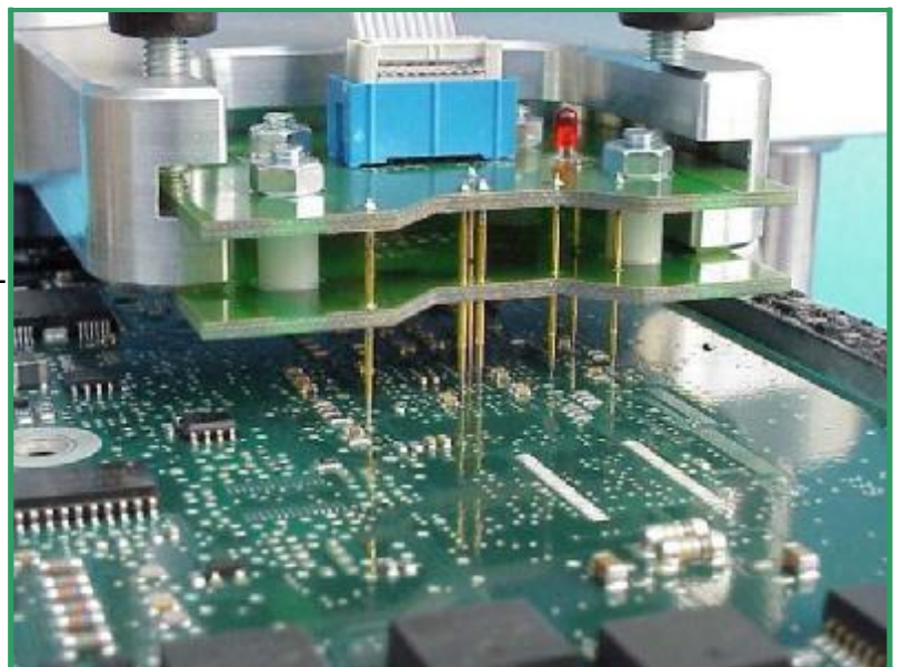
Рис С: Для лучшего контакта, опускайте контакты так, чтобы их подпружиненная часть сжалась не менее 2 мм
